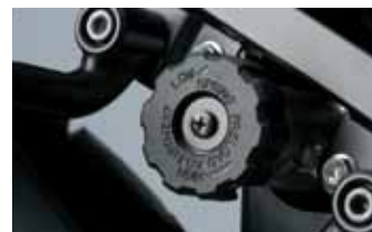
Ajuste de pré-carga da mola.
