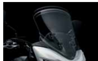
Ajuste de 3 alturas do para-brisas
